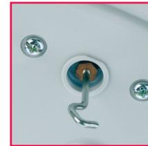
**Crochet de pesée sous balance**
